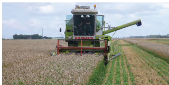
Figuur7| Graanoogst vanaf rijpad met combine op 3.15 meter
