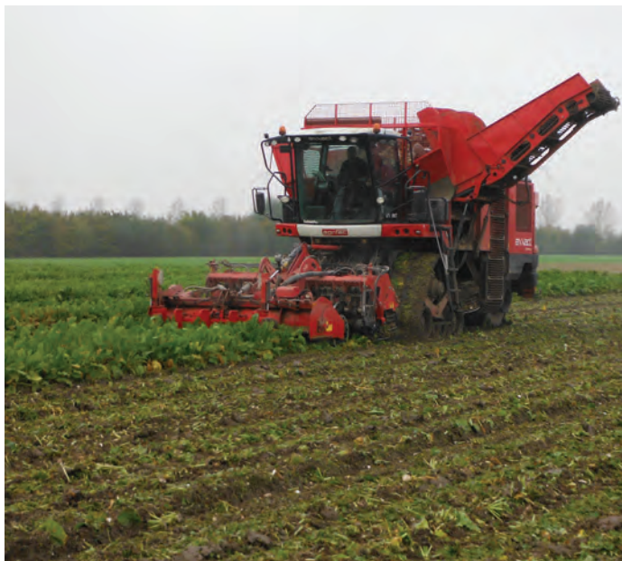
Figuur 1| Suikerbieten oogst met een compacte bietenrooier op rupsen
