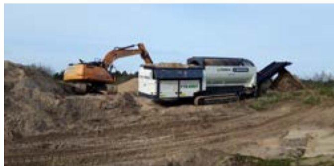
Bestrijding rimpelroos en mahonie door afgraven en zeven van de grond in de duinen.
